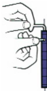
De même, il est également possible de supprimer la fermeture automatique si on le désire. Pour cela, il suffit d'extraire la goupille du bouchon, et ce modèle joue le même rôle qu'une charnière normale.
